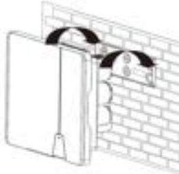
Afb. 6: Omvormer in de wandhouder hangen
