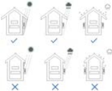
1 pav. Prietaisas, įrengiant lauke
