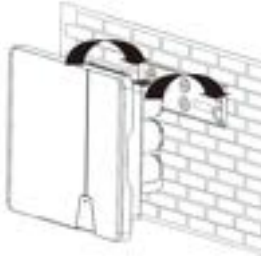
Fig. 6: Enganchar el inversor en el soporte mural
