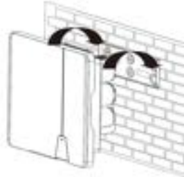
Εικ. 6: Ανάρτηση μετατροπέα στο στήριγμα τοίχου
