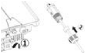
Fig. 18: Introducerea cablului de rețea
