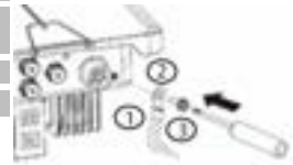
16 pav. Prijunkite įžeminimą
