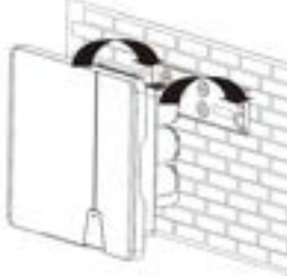
Фиг. 6: Окачване на инвертора към стенния носач
