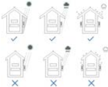
Fig. 1: Enhed ved udendørs montering
