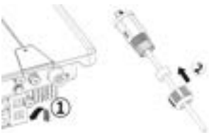
Fig. 18: Føre inn nettverkskabel
