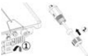
18. att. Tīkla kabeļa ievietošana
