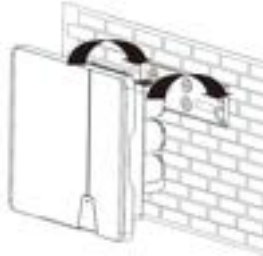
Sl. 6: Ovjese pretvarač u zidni držač
