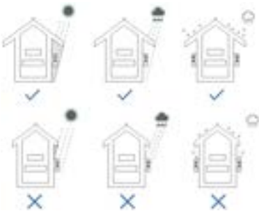
Фиг. 1: Уред при инсталиране на открито
