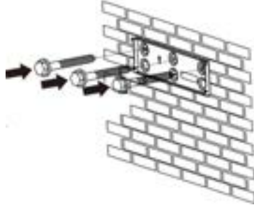
Şek. 5: Duvar tutucusunun montajı
