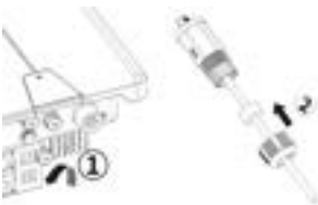
Sl. 18: Vpeljite omrežni kabel
