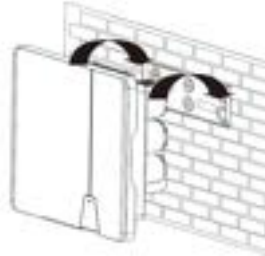
6 pav. Inverterį pakabinkite sieniniame laikiklyje
