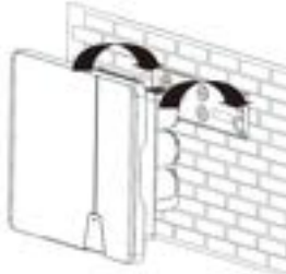
Obr. 6: Zavesenie striedača do nástenného držiaka
