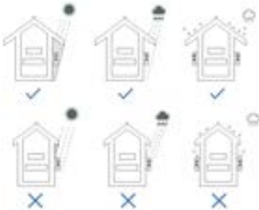
Fig. 1: Enhet vid installation utomhus
