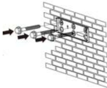
Фиг. 5: Монтаж на стенния носач
