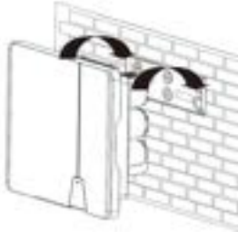
Fig. 6: Häng växelriktaren i väggfästet
