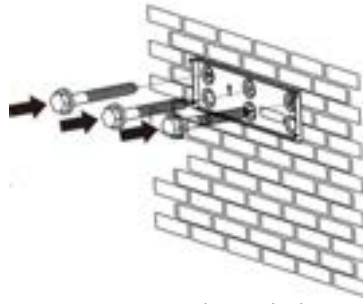
Fig. 5: Montajul suportului de perete
