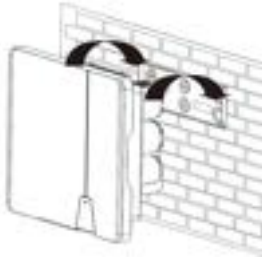
Abb. 6: Wechselrichter in die Wandhalterung einhängen
