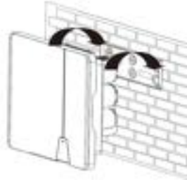
6. ábra: Inverter beakasztása a fal tartóba
