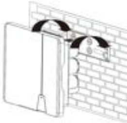
Rys. 6: Wieszanie falownika na uchwycie ściennym
