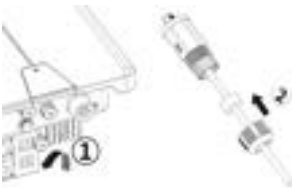
Imm. 18: Introdurre il cavo di rete
