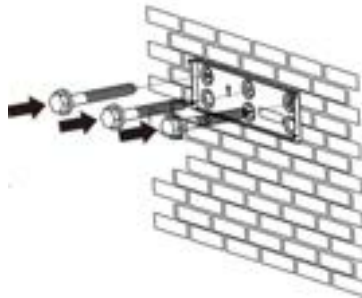
Obr. 5: Montáž nástenného držiaka
