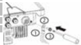
Sl. 16: Priključivanje uzemljenja
