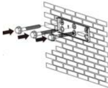
Sl. 5: Montaža zidnog držača
