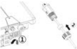
Joonis 18. Võrgukaabli sisestamine
