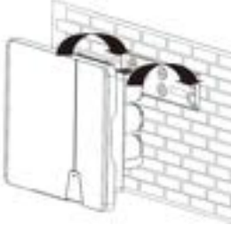
Joonis 6. Inverteri seinahoidikusse haakimine
